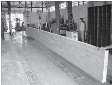
Figura 9 Ensaio de flexão de uma viga de MLC.
