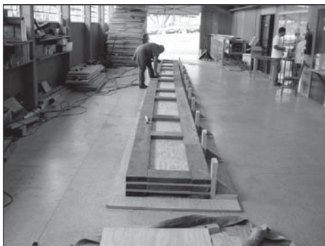
Figura 10 Fabricação de uma viga composta de madeira.
