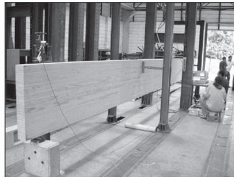
Figura 9 Ensaio de flexão de uma viga de MLC.
