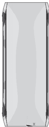
Figura 15 Configuração deformada para níveis de deformação do Modelo PMC-19, para K_{PM} igual a 0,75 e tempo de exposição ao fogo igual a 17 minutos.
